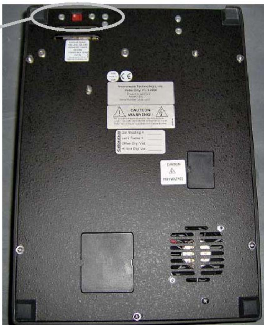
Когда в окошке переключателя вы видите обозначение 230В, прибор установлен на напряжение 230В. Если вы подключили прибор в сеть с напряжением 115В, когда установлено 230В, прибору будет недостаточно рабочего напряжения.
