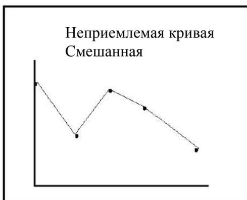
В методе используется расчет концентраций неизвестных проб в соответствии с законом Веера. Калибровочная кривая образуется серией отрезков, соединяющих точки калибраторов. Если вы хотите использовать точку (0,0), вы должны включить ее как калибратор. Неизвестные пробы рассчитываются следующим образом:
