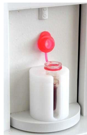
Пробирку с колпачком всегда нужно размещать в таком положении, иначе колпачок может застрять при повороте держателя
