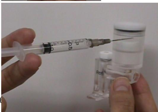
6. Введите раствор в емкость твердофазного KCL через инъекционное отверстие до уровня отверстия.
