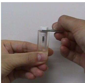
1. Извлеките внутреннюю часть электрода с помощью гаечного ключа
