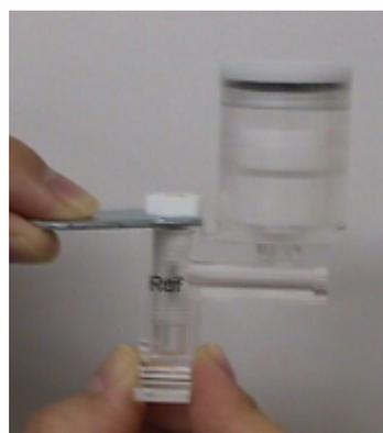
3. Накрепко закрутите с помощью гаечного ключа
