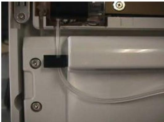
5. Закройте крышку датчика потока
