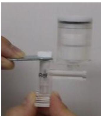
3. Накрепко закрутите с помощью гаечного ключа
