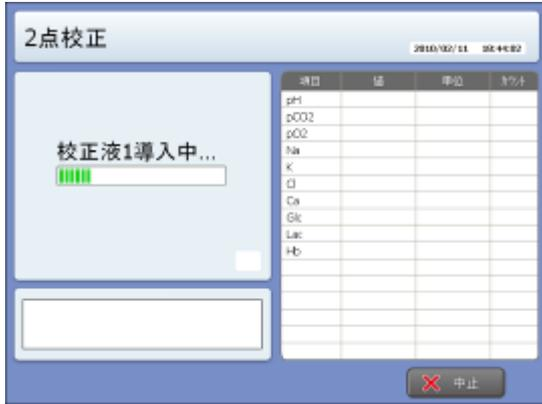
3. Калибровочная жидкость подается в канал пробы. Если результат выходит за пределы диапазона, прибор повторяет калибровку.
