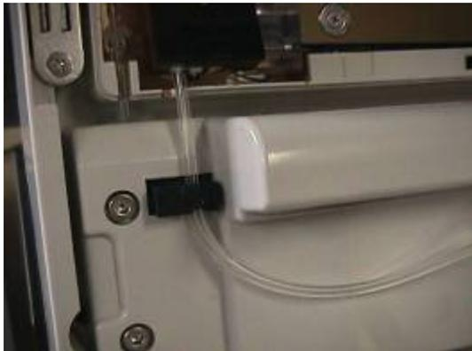
4. Подсоедините трубку пробоотборника к трубке измерительного модуля и заложите ее в паз.
