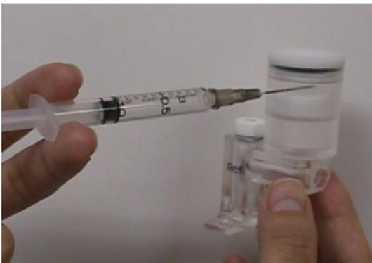
6. Введите раствор в емкость твердофазного KCL через инъекционное отверстие до уровня отверстия. Вытрите отверстие и закройте герметиком.
