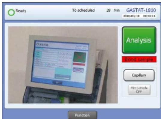
1. Проверьте готовность прибора (сообщение «Ready» в строке состояния на главном экране) и готовность пробы крови.
