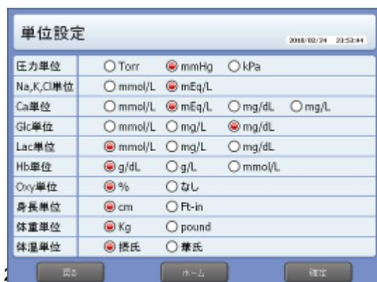
1. Нажмите кнопку выбора единиц измерения «Unit setting», чтобы выбрать единицу измерения каждого параметра
