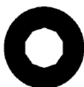
Поле зрения после выравнивания конденсора
