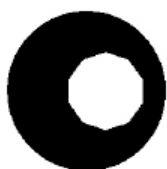
Поле зрения перед выравниванием конденсора
