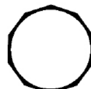
Полностью открытая полевая диафрагма
