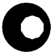
Поле зрения перед выравниванием конденсора
