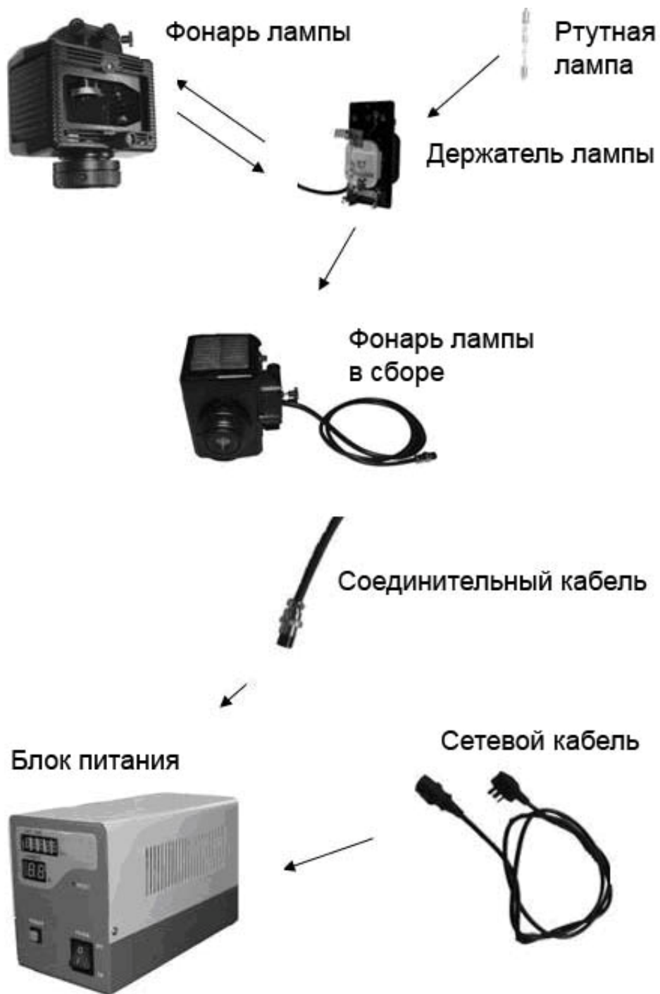
Рис.16. Схема сборки флюоресцентного блока
