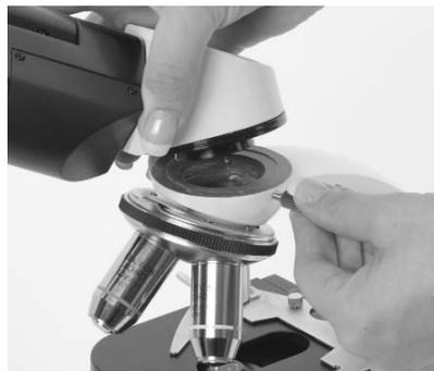
Рис. 1. Установка визуальной насадки.
