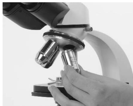
Рис. 3. Установка объективов
