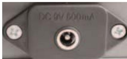
Рис.5. Разъем для подключения сетевого адаптера на задней панели основания.
