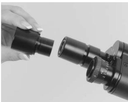
Рис. 2. Установка окуляров в окулярные трубки
