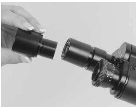
Рис. 2. Установка окуляров в окулярные трубки
