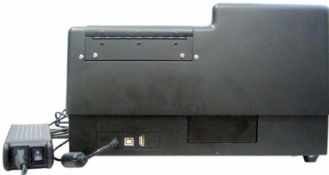
Рисунок 1.6.2-2 Блок питания AC, прикрепленный к задней стороне StatFax 4200
