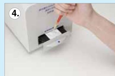
Капните 100 мкл пробы в 2 отверстия
