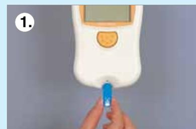
1. Вставьте картридж в разъем, анализатор включится автоматически
