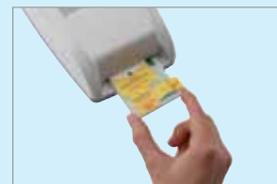
Вставьте измерительный картридж в разъем для картриджей на приборе
