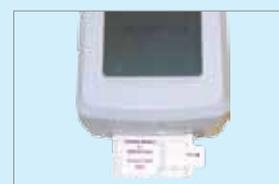
Автоматическая калибровка по встроенному калибратору
