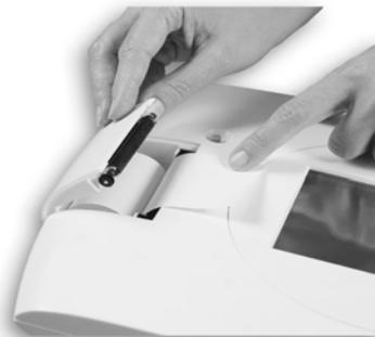
Рисунок 4. Загрузка бумаги принтера
