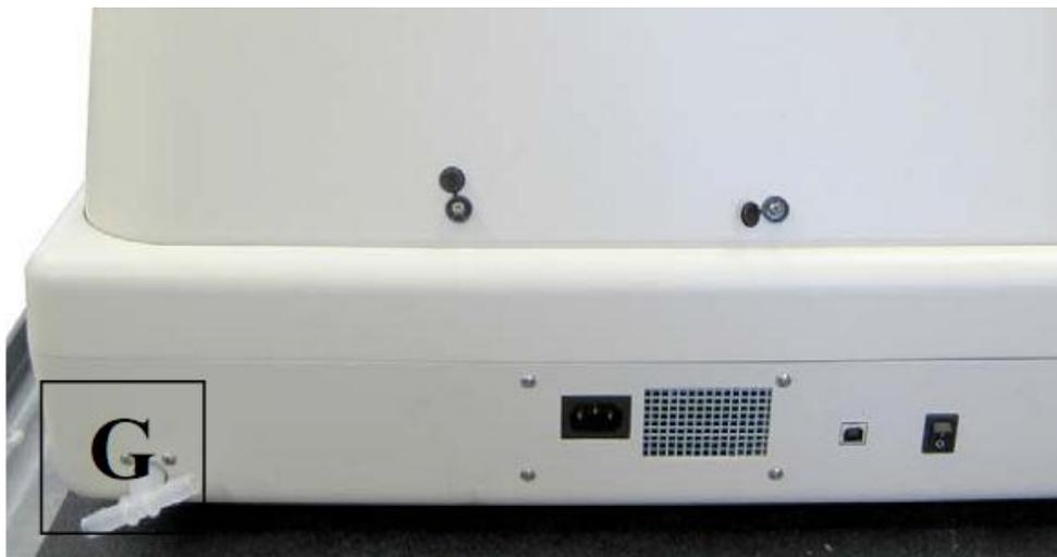
Установите крышку на контейнер отходов и подсоедините трубку к тройнику «G» (см. «Н»). Поместите контейнер отходов ниже уровня тройника, чтобы обеспечить отток жидкости:
