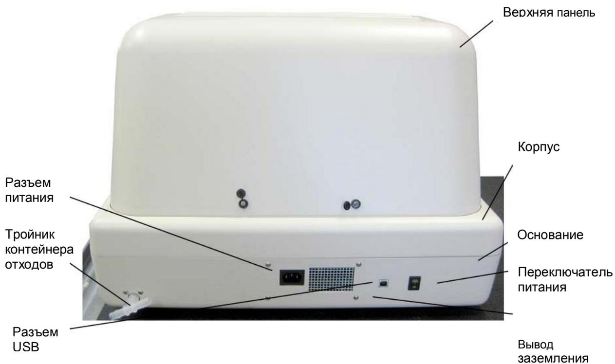
Рис.2.5.1 – 2. Внешний вид прибора, вид сзади
